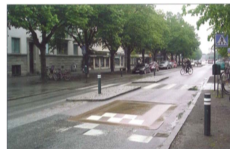
Almohada protegiendo el paso de peatones en Malmo (Suecia). Fuente: "Calmar el tráfico". Ministerio de Fomento.
