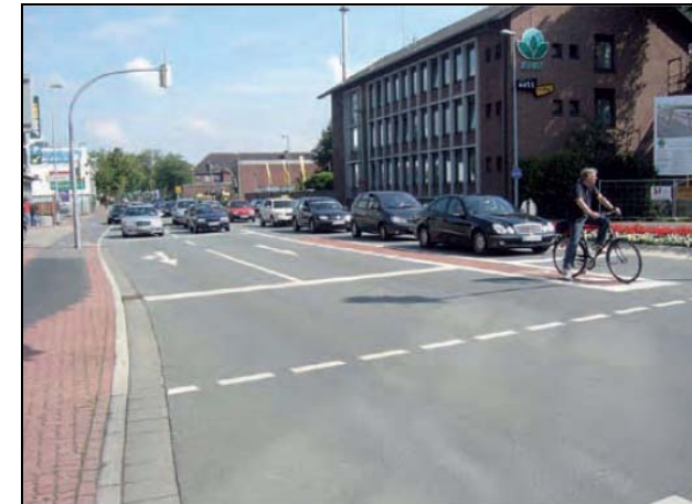
Carril especial de giro a la izquierda con parada adelantada en Münster.
