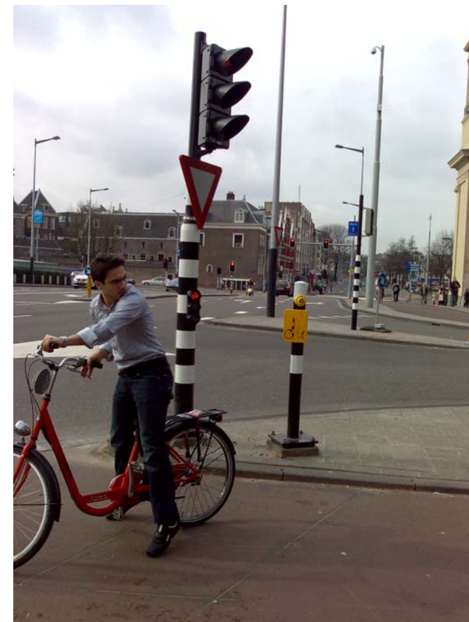
Ejemplo de semáforo ciclista con las tres fases y pulsador. Foto: Amsterdam
