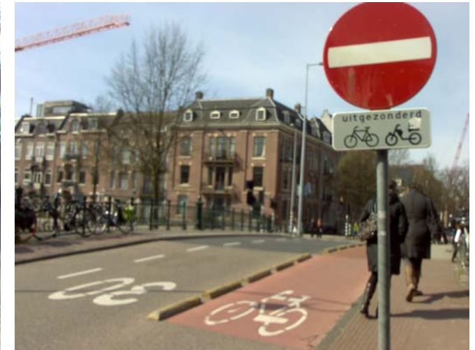
Ejemplo de circulación a contramano con protección.
