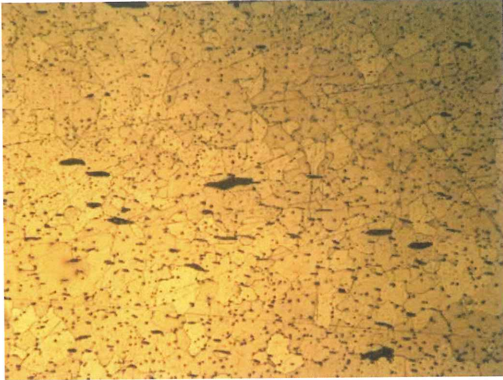
Micrografía 3. Muestra 17M093-1. X100 Aumentos. Ataque con Nital
