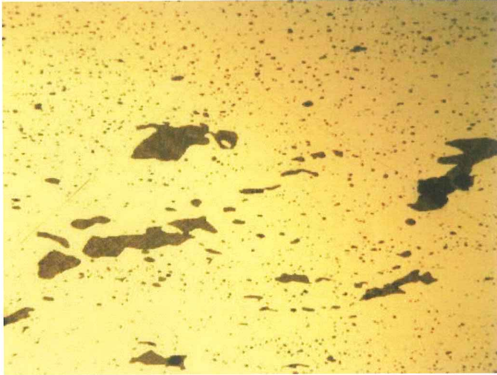
Micrografía 1. Muestra 17M093-1. X100 Aumentos. Sin ataque
