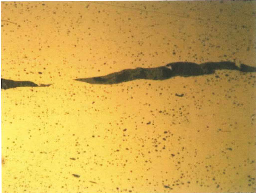
Micrografía 2. Muestra 17M093-1. X100 Aumentos. Sin ataque
