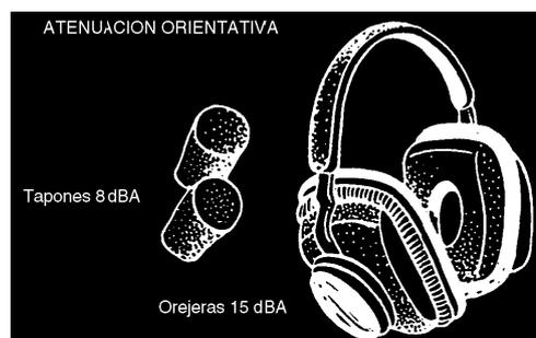
**Tapones:** Son protectores diseñados para ser ajustados en la parte externa del conducto auditivo y permanecer en esta posición sin ningún dispositivo de fijación externo. Pueden ser construidos de goma, plástico o materiales similares en gran diversidad de modelos. También se dispone de tapones hechos con relleno orgánico impregnado con cera o algún aglutinante.
