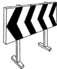
VALLA DE DESVIAMIENTO DE TRAFICO
