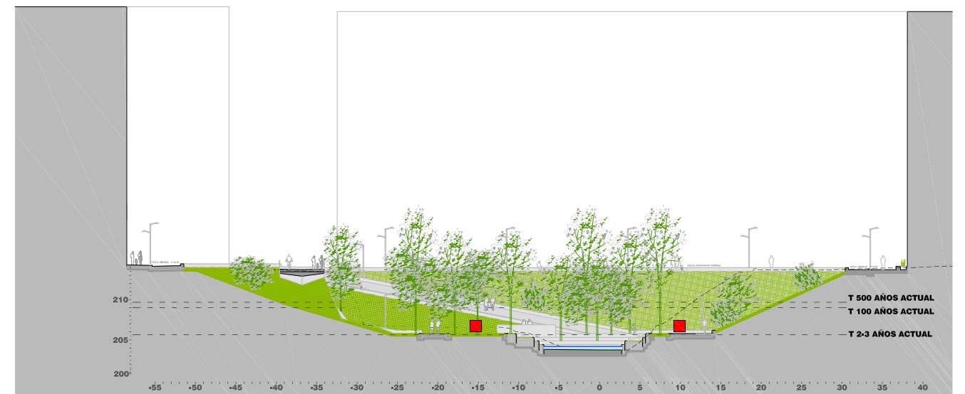
"PLAZA VERDE" INFERIOR A COTA DE AVENIDA DE 500 AÑOS SECCIÓN TRANSVERSAL 2 ZONA PUENTE EMPERADOR AGUSTO
