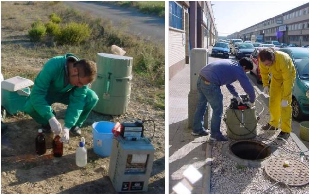
Fig. 5 Muestras en polígonos industriales donde se determina el caudal, la medición en continuo de parámetros físicos y muestreos integrados de 24 horas
