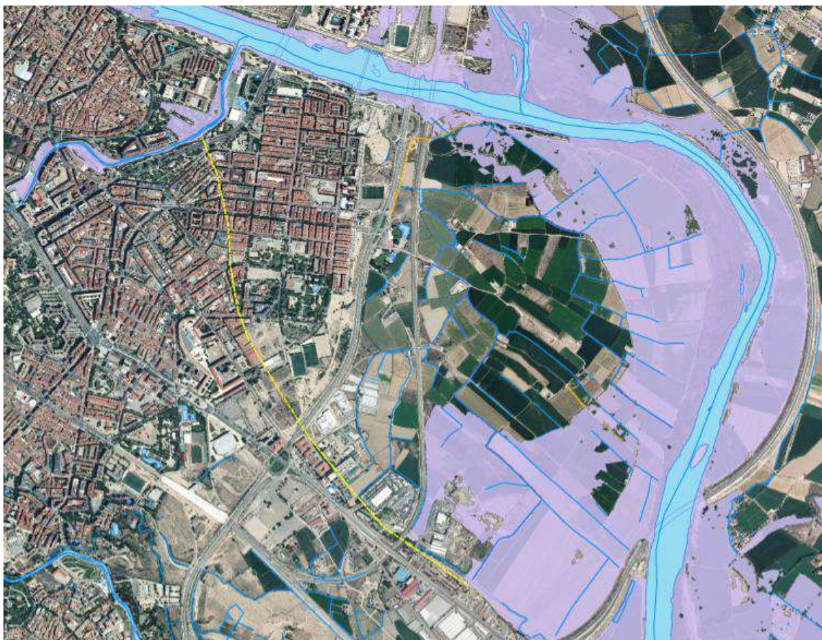
Fig.91: Curva de inundabilidad del Soto de Cantalobos. Red de acequias entre el barrio de las Fuentes y el espacio de huerta. Caminos municipales en amarillo. (Fuente: CNIG y ATALAYA)
