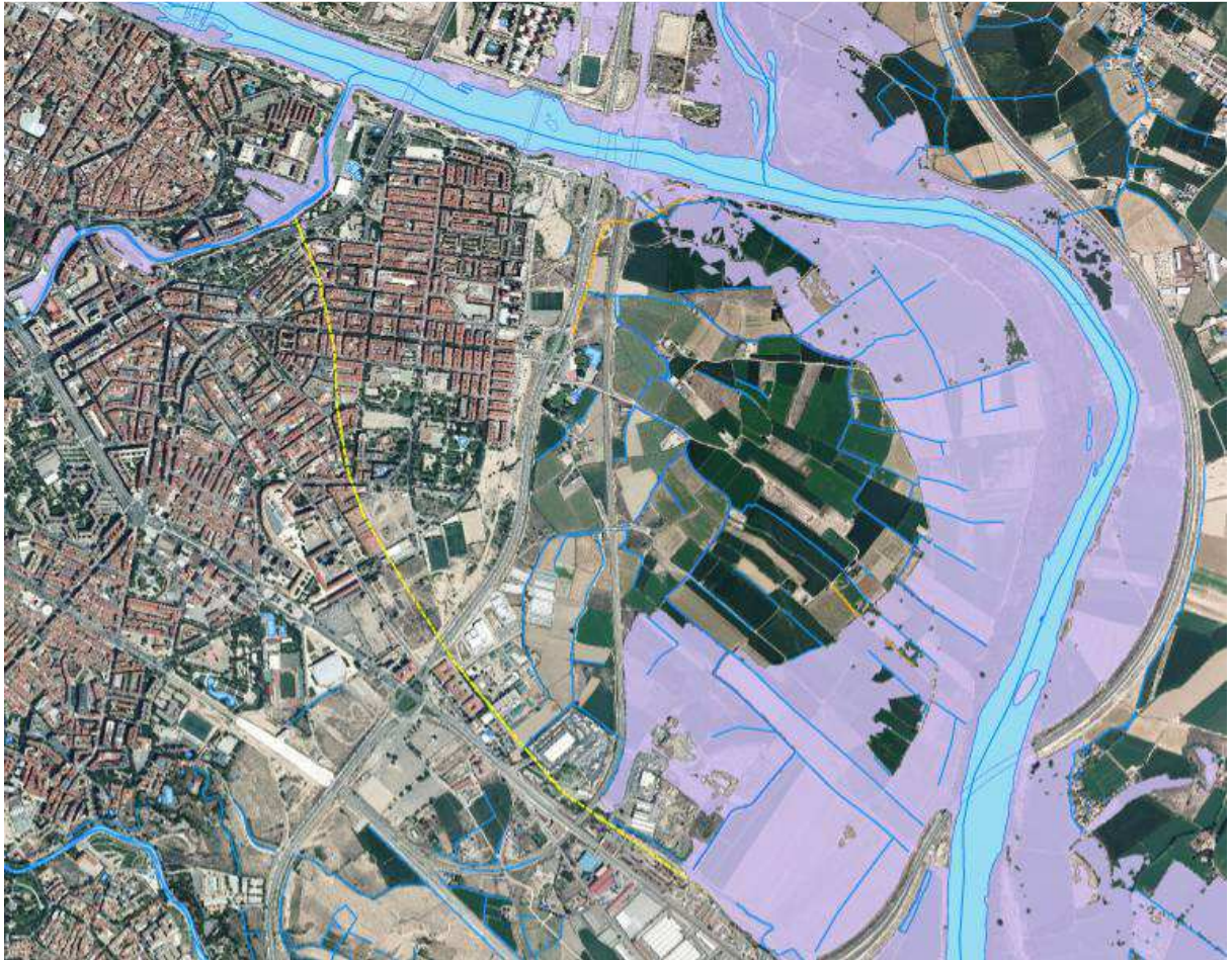
CURVA DE INUNDABILIDAD DEL SOTO DE CANTALOBOS. RED DE ACEQUIAS ENTRE EL BARRIO DE LAS FUENTES Y EL ESPACIO DE HUERTA. CAMINOS MUNICIPALES EN AMARILLO
